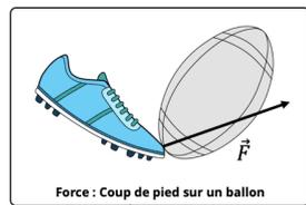
Une force F modélise l'interaction d'un objet sur un autre en un point de l'espace. Elle est représentée par un vecteur (point d'application, direction, sens, et norme). Son unité est le Newton N
